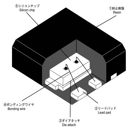
項目 材料 備考 Item Material Note 1 封止樹脂 エポキシ樹脂 難燃グレード/Flammability rating UL94V-0 Resin Epoxy resin リードパッド ニッケル Nickel Lead pad 2 \_ Auメッキ 端子処理 端子側面は除く Gold plating Except the side of the terminals. Outer pad plating 3 ダイアタッチ エポキシ Die attach Ероху 4 ボンディングワイヤ Au Bonding wire シリコンチップ **(5)** Si Silicon chip
